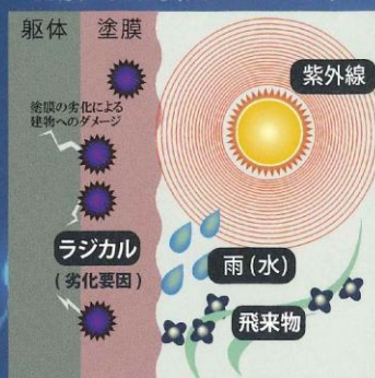
塗膜の劣化要因が生じるしくみ
